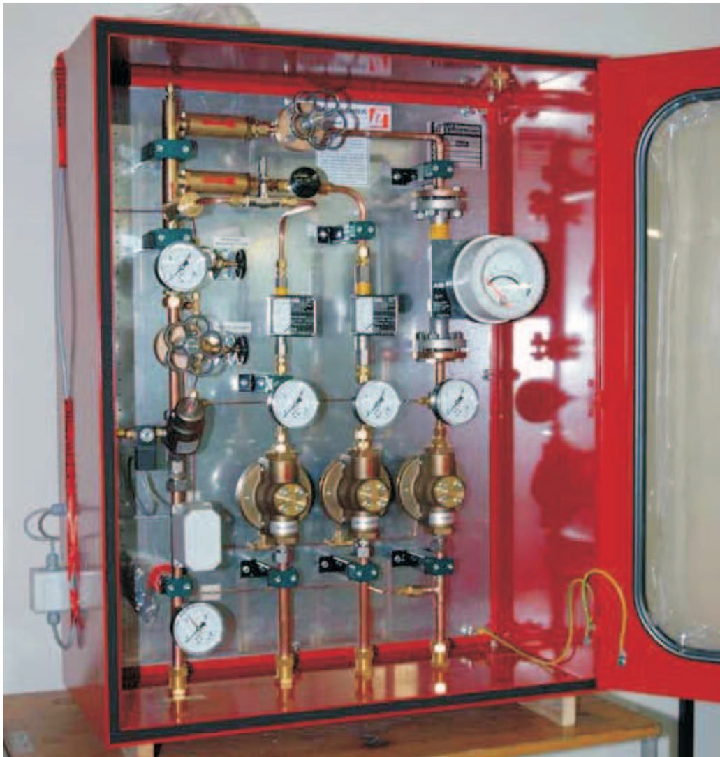
На фото: Газовые смесители L+T серии BASIC для трёх невоспламеняющихся газов
